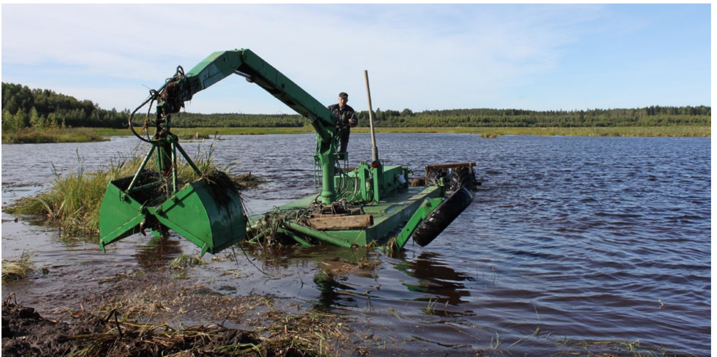
Ponttoonilla leikattiin aluksi turvelaudat irti ja laskettiin vetoverkko niiden taakse. Ponttoonin käyttäjänä toimi yrittäjä Kalevi Pelkonen.
